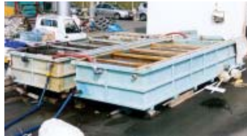
海水流下水槽(幅 2m × 長さ 5m × 高さ 0.9m × 2)
